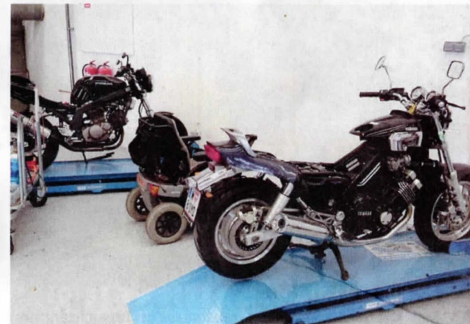
■ Zwei spezielle Hebebühnen erleichtern kompliziertere Arbeiten an Motorrädern ungemein.
